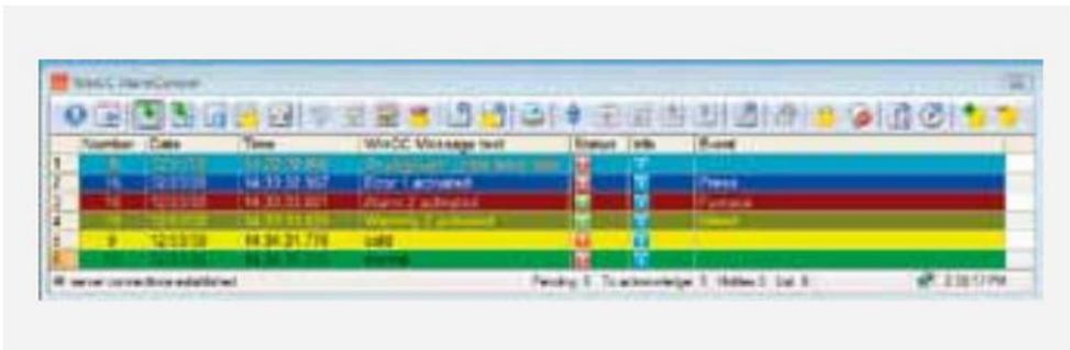
根据每个报警块内容的不同，可按优先级、故障位置或时间顺序对报警进行筛选、选择和分类。随后可以将报警内容直接导出为 CSV 文件或打印为报表。可自由定义的工具栏功
